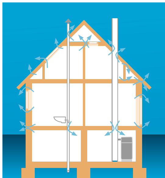
Abb. 7-46 Wärmeverluste durch Undichtigkeiten
