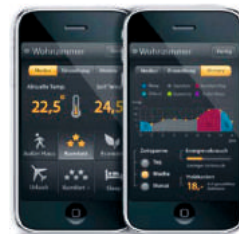
Abb. 8-56 Heizungssteuerung mittels Smartphone
