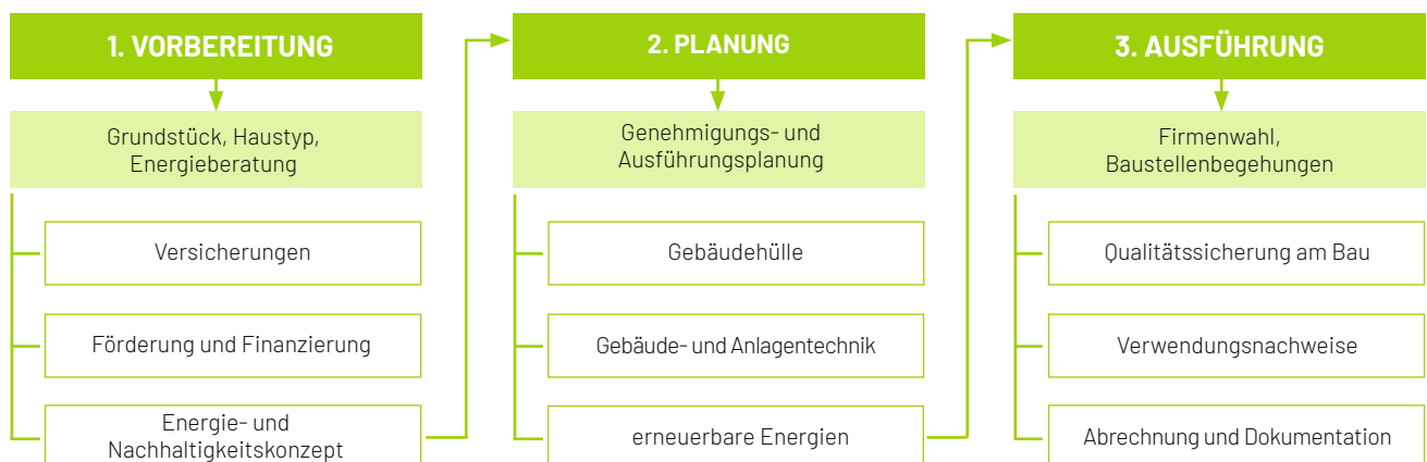
Abb. 1-4 Ablaufplan eines Neubau- oder Sanierungsvorhabens
