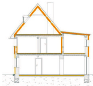
Abb. 12-11 Darstellung thermische Gebäudehülle
